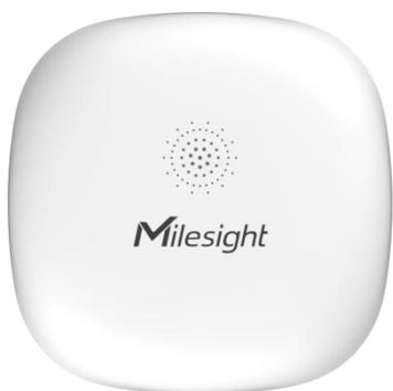
星纵物联 WS303 是一款小巧耐用的一体式智能水浸传感器，利用液体导电性原理，通过电极检测漏水情况。一旦发生漏水，WS303 将立即触发本地蜂鸣器报警，并及时告警到平台端。
